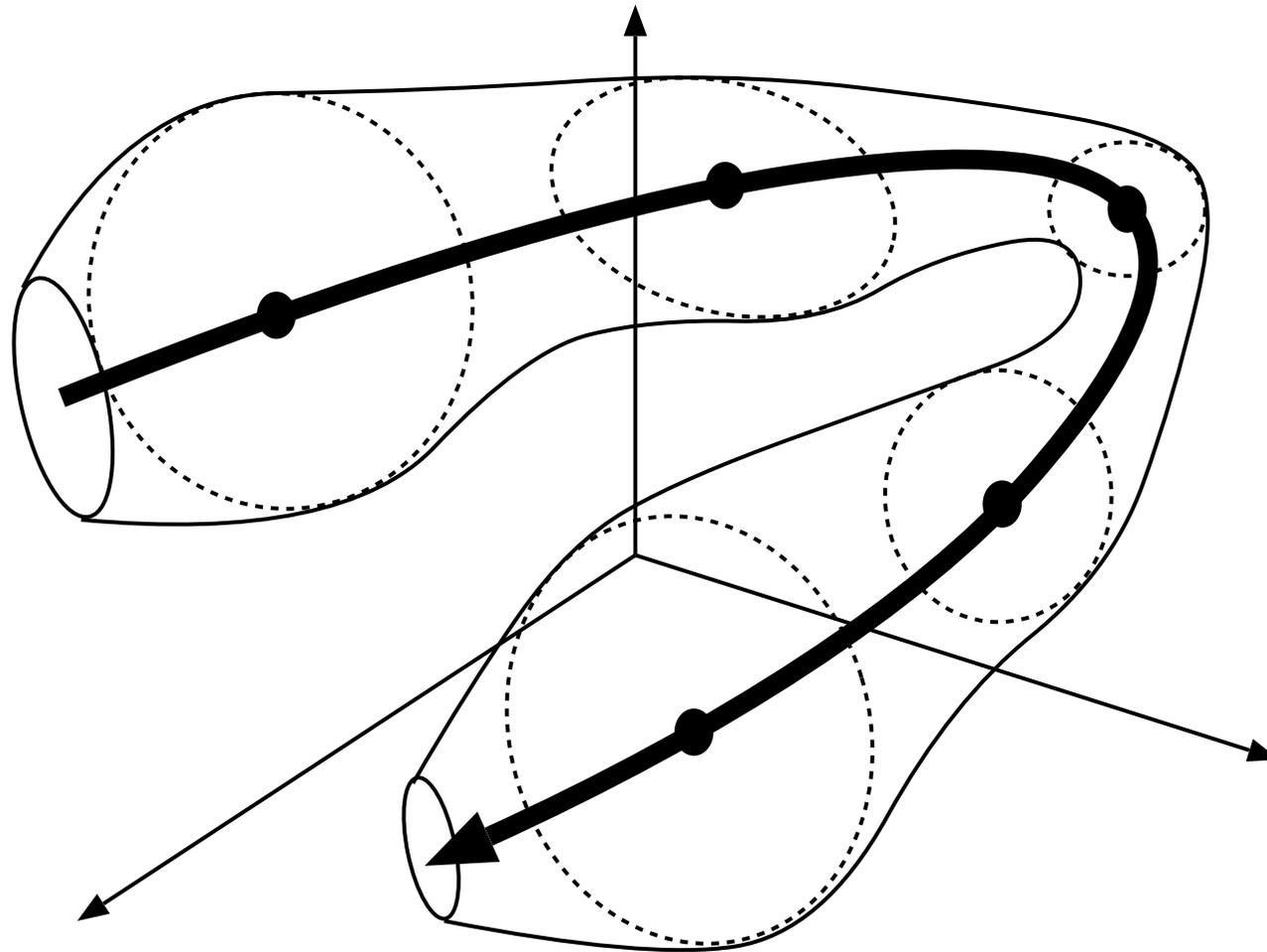
図6. 変動の大小に応じて管の太さを場所によって変える。すなわちマハラノビス距離などを使用する。そうすれば時間的にも粗くできる。これがHMMであると理解して良い。
