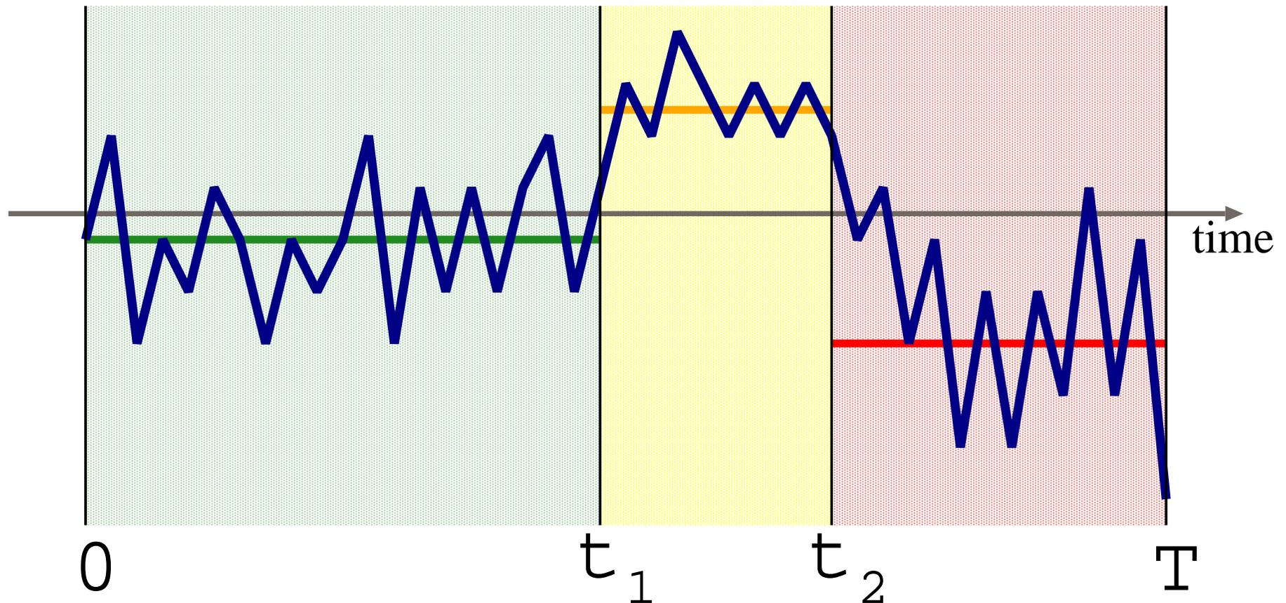
図 8.  $K$  個の区間を持つ階段関数で置き換える。距離の二乗総和を最小とする。  $t_1, t_2$  はどのように求めるか。
