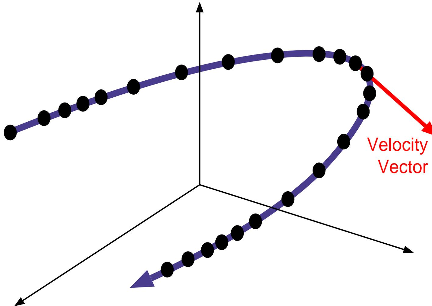
図4. 音声特徴ベクトルの時系列は特徴空間上の点の運動軌跡と捉えることができる。
