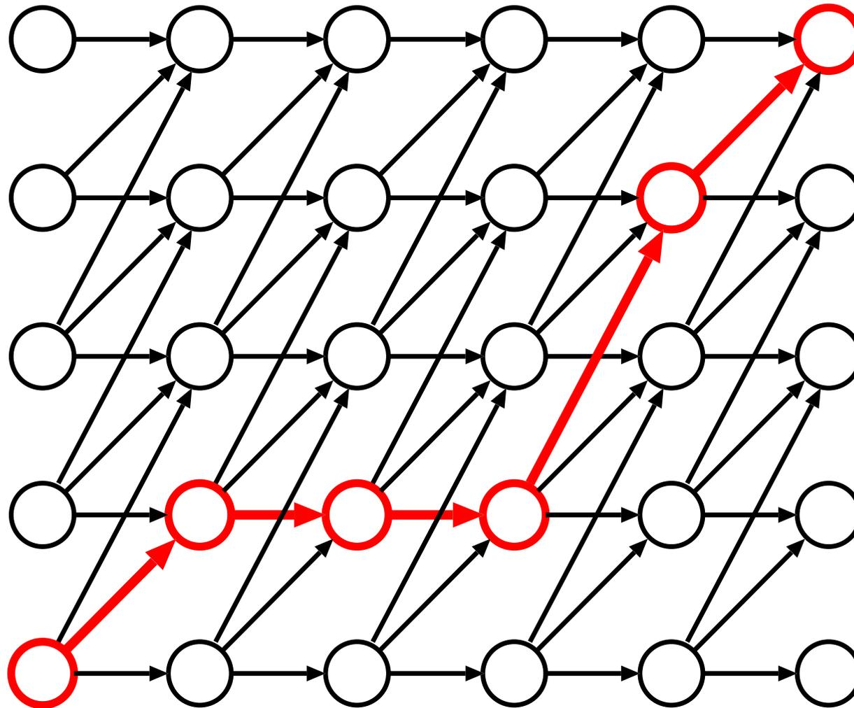
図3. 節点(丸)と枝(矢印)の両方にコスト(距離)が定義されている。
