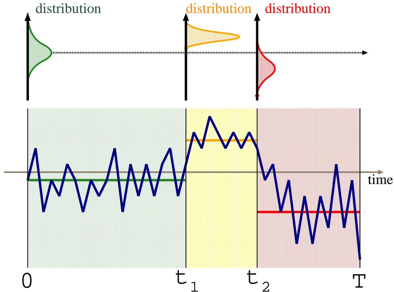
図9. 距離がマハラノビス距離で定義されている場合、距離の二乗総和を最小とするように  $t_1, t_2$  を決定する。
