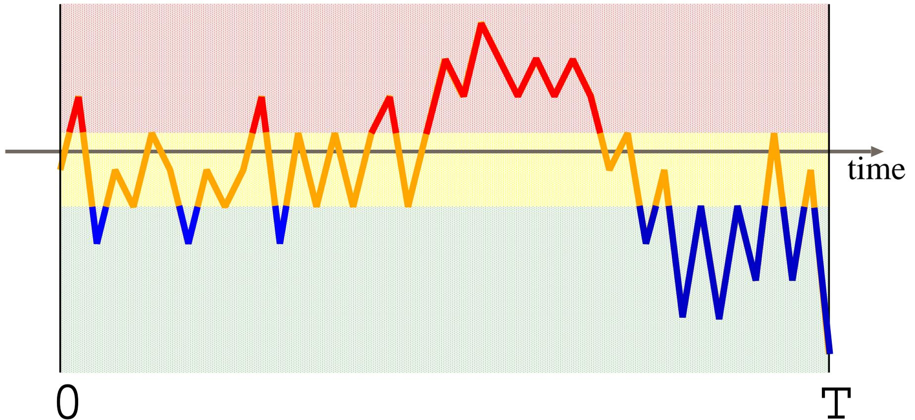
図7. 全区間の値の集合を  $k$ -means アルゴリズムによりクラスタリングする。二乗距離の総和を最小とする。
