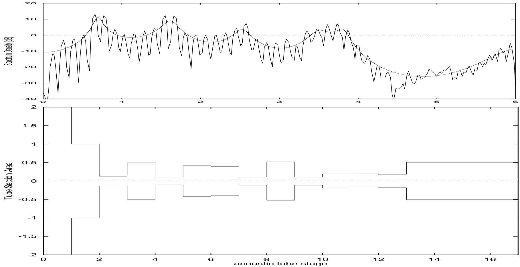
図：音声のスペクトルとLPC推定例(男声 /a/) - 左端が口，右端が声門に相当
