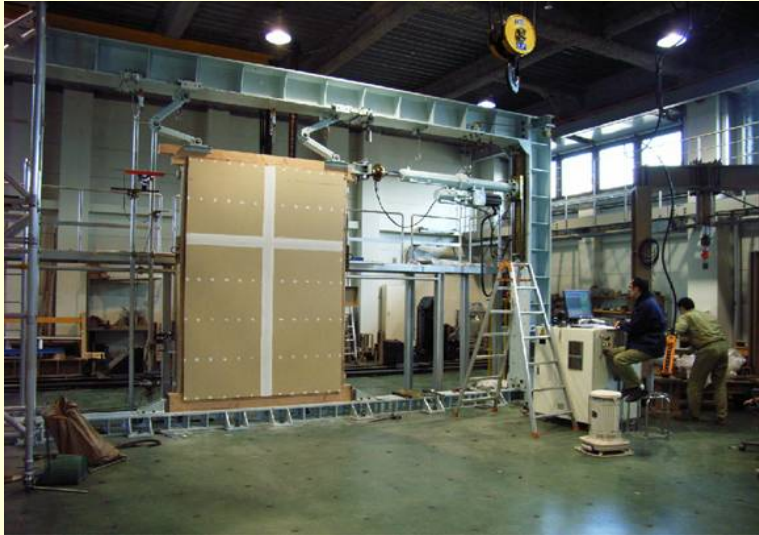
中・大地震相当のせん断耐力試験
