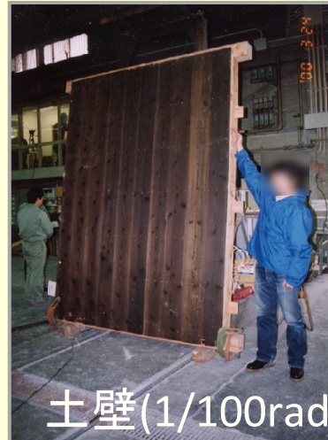
中・大地震相当のせん断耐力試験
