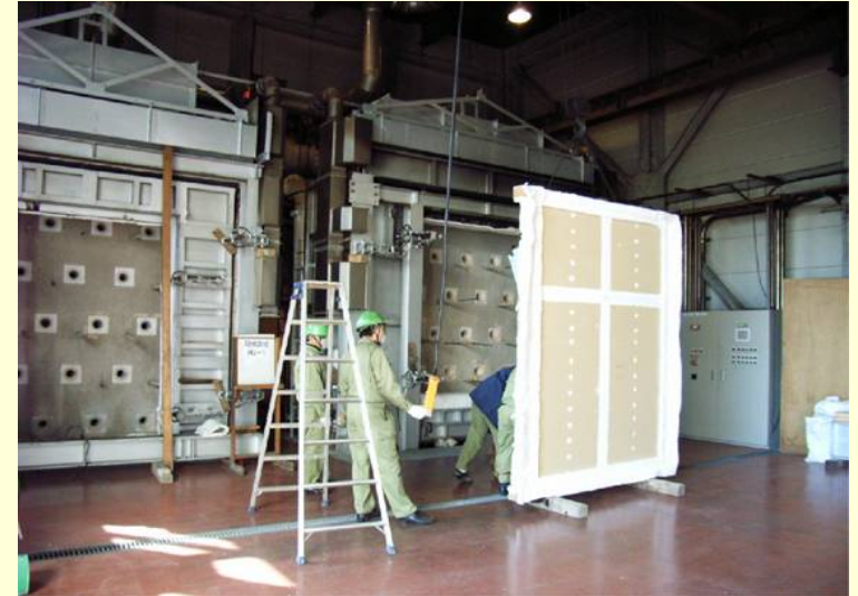
その後、載荷加熱試験(荷重は2階建住宅想定)
