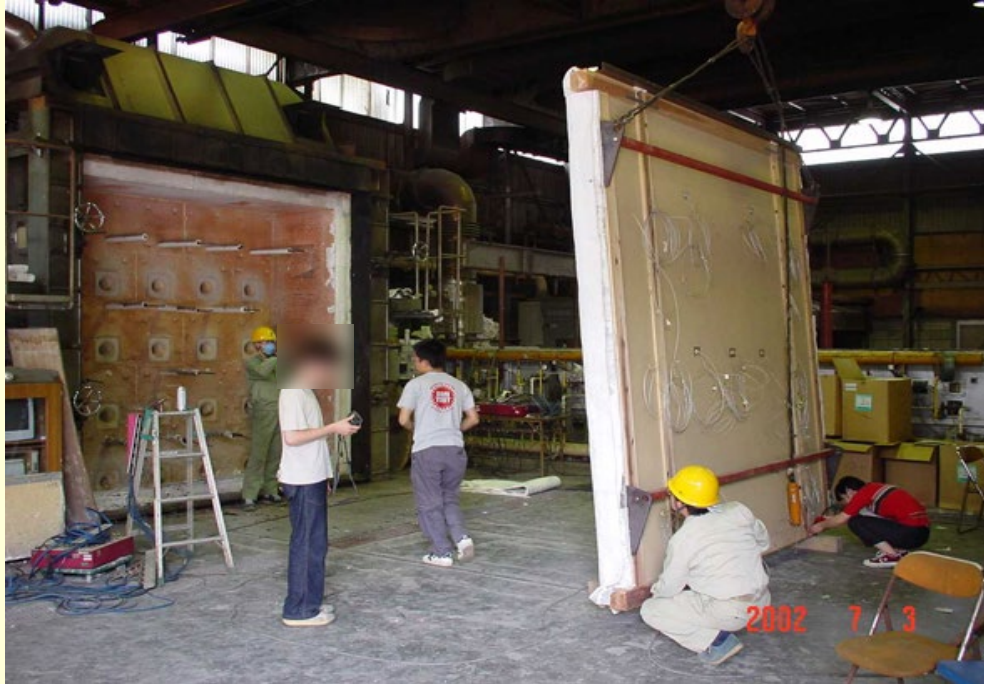
耐火炉と土壁試験体
